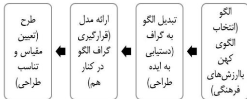
نمودار ۲. فرآیند دستیابی به رفتار الگو و تسری به طراحی معماری معاصر
