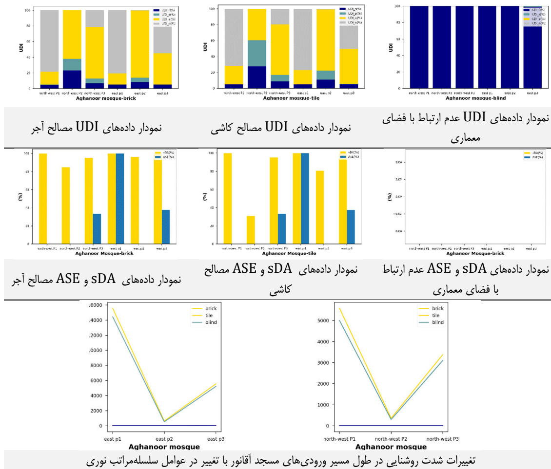
جدول ۶ نمودارهای نتایج شبیه سازی شاخص های روشنایی در ورودی های مسجد آقانور
